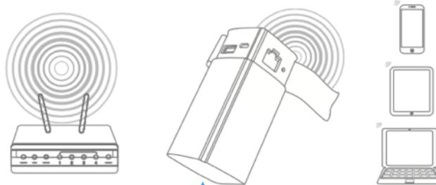
La borne wi-fi Hootoo permet aussi de relayer un signal wi-fi ce qui permet d'augmenter la portée de son réseau Wi-fi
